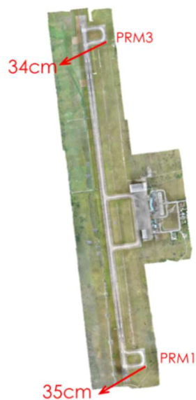
図 6. フィリピン・ジェネラルサントス空港の GNSS 測量点 2 点の 2002 年～2018 年の水平変動。
