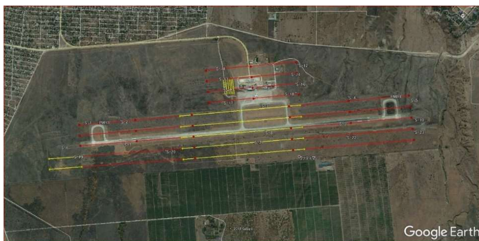
図 5. ジェネラルサントス空港のドローンを用いた航空測量の飛行経路
