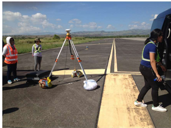
写真 2 NIMA が作成したベンチマークの の上で行った GNSS 測量風景
